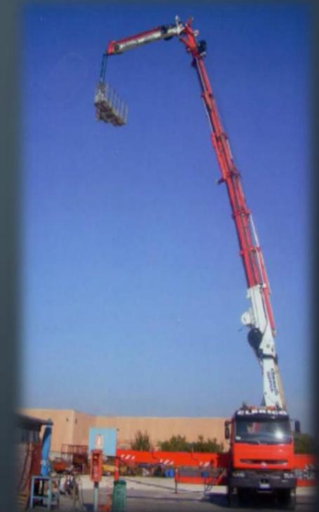
Производим разработку ПОЖАРНЫХ АВТОПОДЪЕМНИКОВ и машин с гидравлическими телескопическими стрелами с дополнительными секциями. Высота подъема от 32м.
